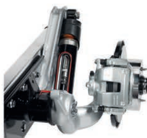
Suspension arrière ALC : position constante quelle que soit la charge
